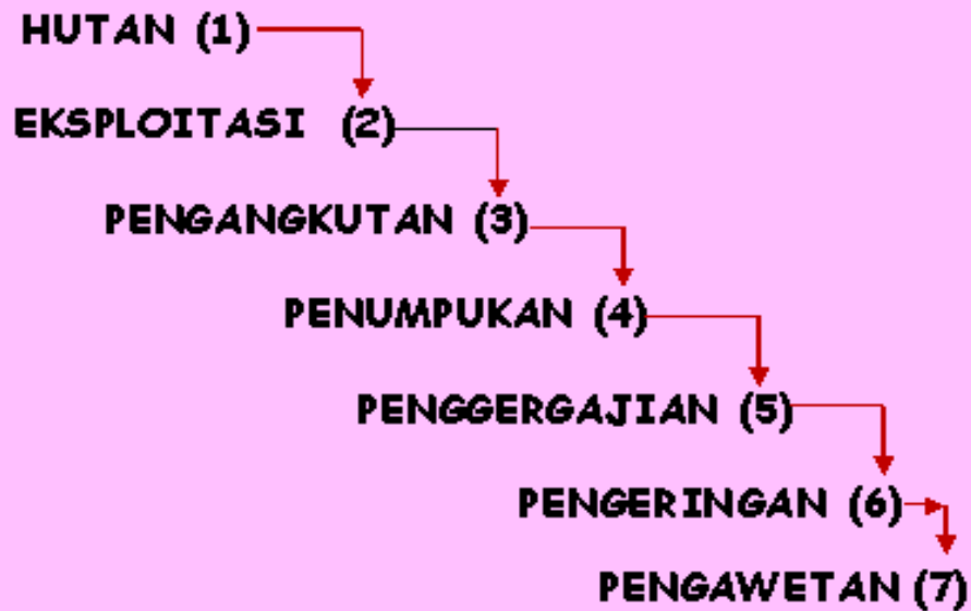
Gambar 1. Simplifikasi tata aliran proses produksi dan pengolahan hasil hutan
